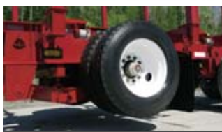
Suspension relevable Manac à haut dégagement
